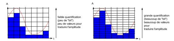
Plus la quantification est grande, plus l'amplitude du signal numérique sera proche de celle du signal analogique.
