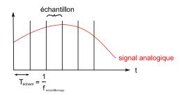
Plus la fréquence d'échantillonnage sera grande, plus le nombre d'échantillons sera grand, plus le signal numérique « collera » au signal analogique et donc meilleure sera la numérisation :
